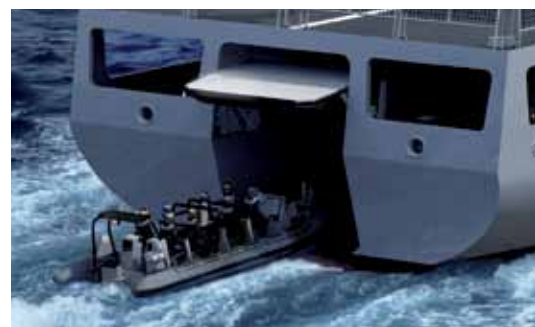
▲ STERN SLIPWAY OPV 1400 ▼ OPV 1400
